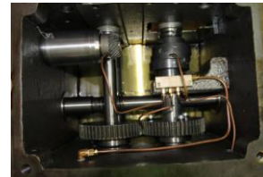
Tecnología anterior. (Transmisión completa con todos sus engranes)
