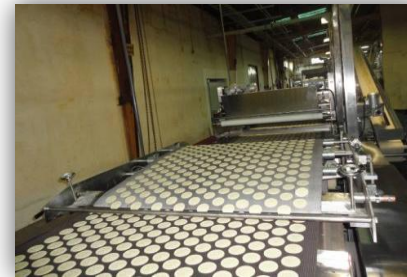
Planta piloto de elaboración de galletas para validar harina de trigo grupo I
